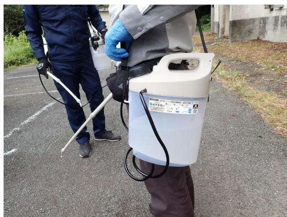
図 4：既存の肩掛け式液剤散布機を、粘度のある生分解性MFC ハイドロジェルベイト剤を排出できるように改良したハイドロジェルベイト剤散布機。
