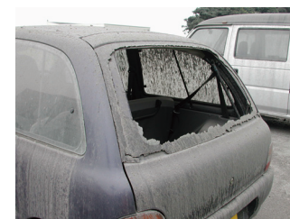
噴石で割れた車のガラス
